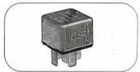
Über das Schrittrelais für ABS wird das System über Klemme 50 oder von Hand mit dem ABS-Schalter eingeschaltet. Das Relais sitzt links unter der Schalttafel auf der Steckleiste.
