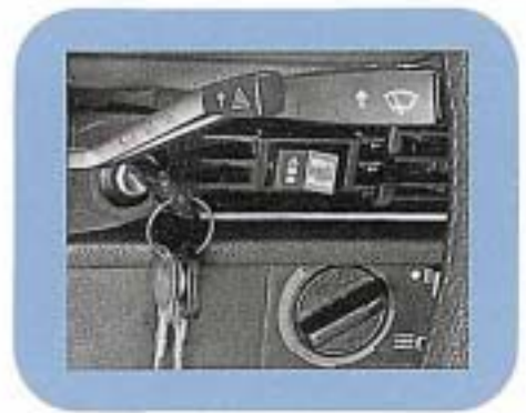
Der Schalter für das ABS bietet die Möglichkeit, das System in bestimmten Ausnahmesituationen abzuschalten.
