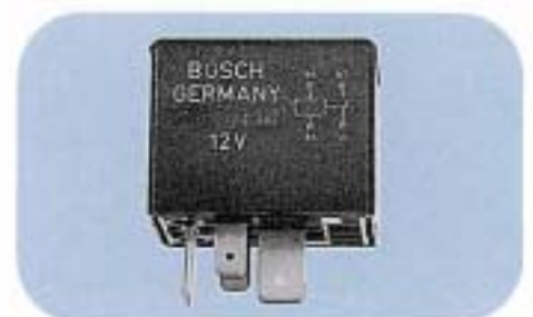
Über das Relais für die Rückförderpumpe wird der Pumpenmotor angesteuert. Das Relais sitzt im Kunststoffgehäuse der Hydraulikeinheit.
